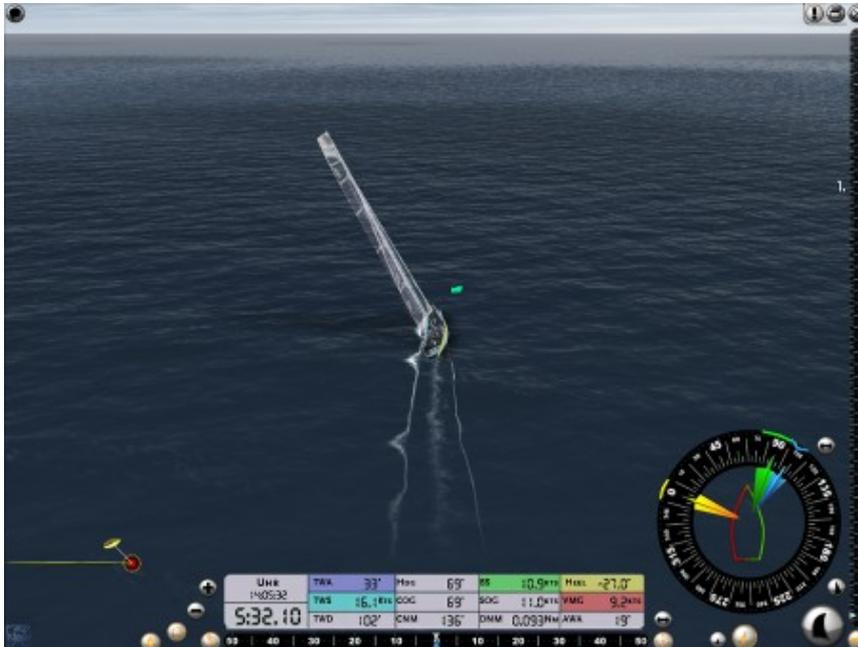
In diesem Bild sehen wir einen TWA (True Wind Angle) von 33°. Dies ist der Winkel den wir am Wind fahren.
